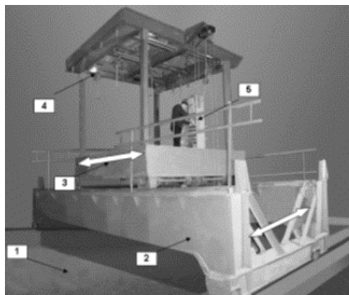
Рисунок 4 - Внешний вид мостового устройства КПС: 1 – измерительный бассейн; 2 – подвижное мостовое устройство; 3 – перемещаемая платформа; 4 – система позиционирования преобразователей СПП; 5 – стойка управления СУ КПС
