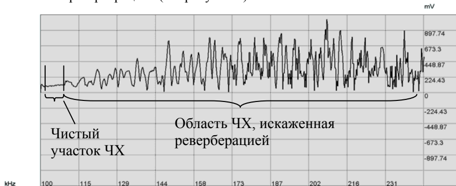
Рисунок 2 - АЧХ пары излучатель-приёмник
