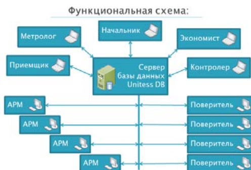
Рисунок 2 - Функциональная схема системы UniTesS
