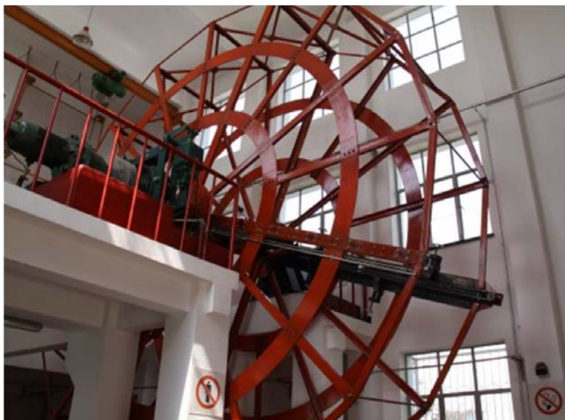
Рисунок 2 - Установка для калибровки волномерных буев, National Center of Ocean Standards And Metrology, Китай
