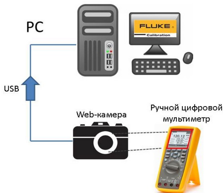
Рисунок 7 - Система машинного зрения для распознавания показаний цифровых мультиметров
