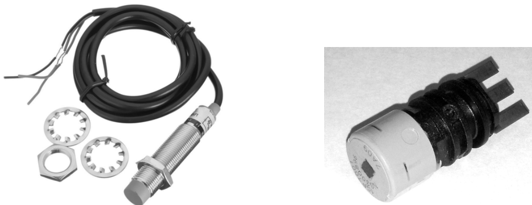
Рисунок 8 - Примеры преобразователей на эффекте Холла
