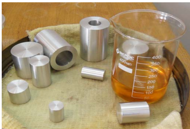
Рисунок 2 - Горизонтальные и вертикальные вставки в тигель
