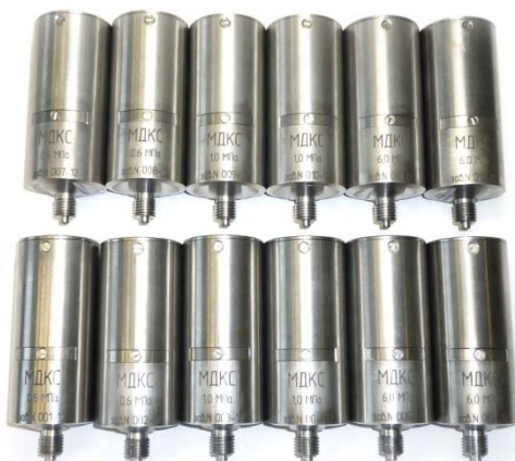
Рисунок 7 - Цифровые электронные модули давления МДКС
