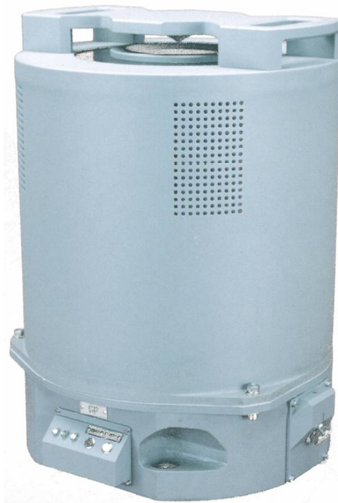
Рисунок 2 - Внешний вид модернизированного гравиметра
