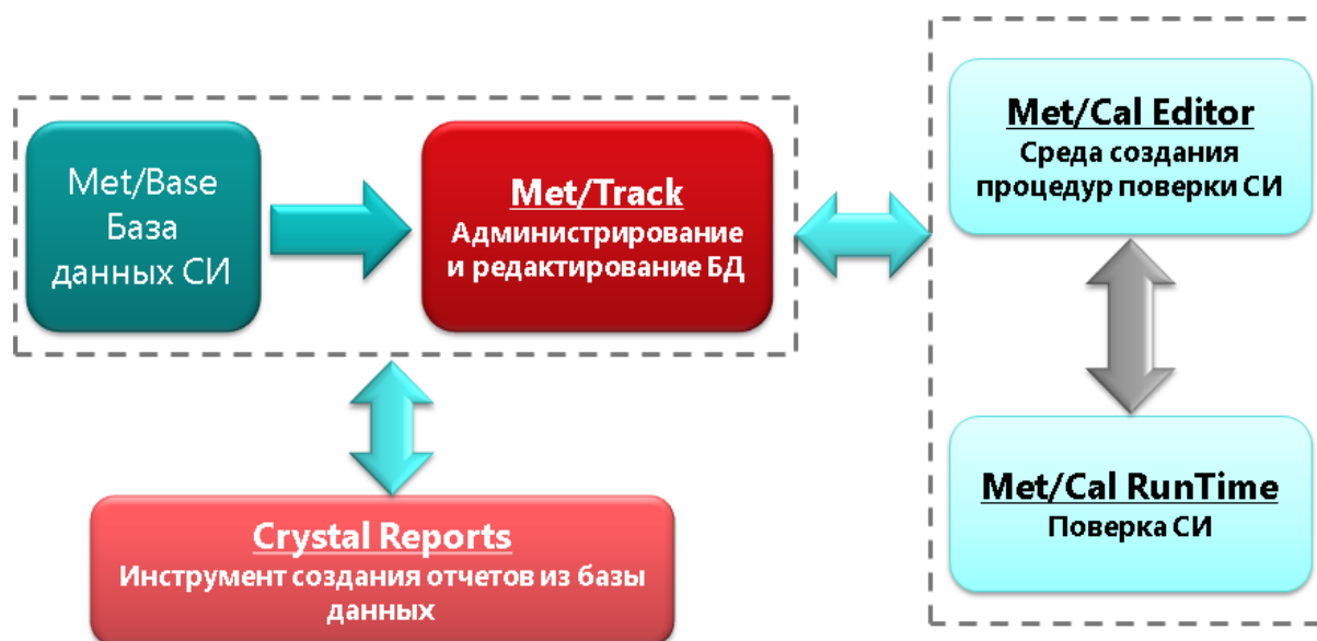
Рисунок 4 - Структура программного обеспечения Fluke Met/Cal
